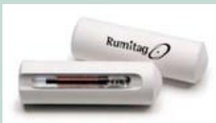
*Желудочный болус в разрезе; виден микрочип размером 32 мм*
